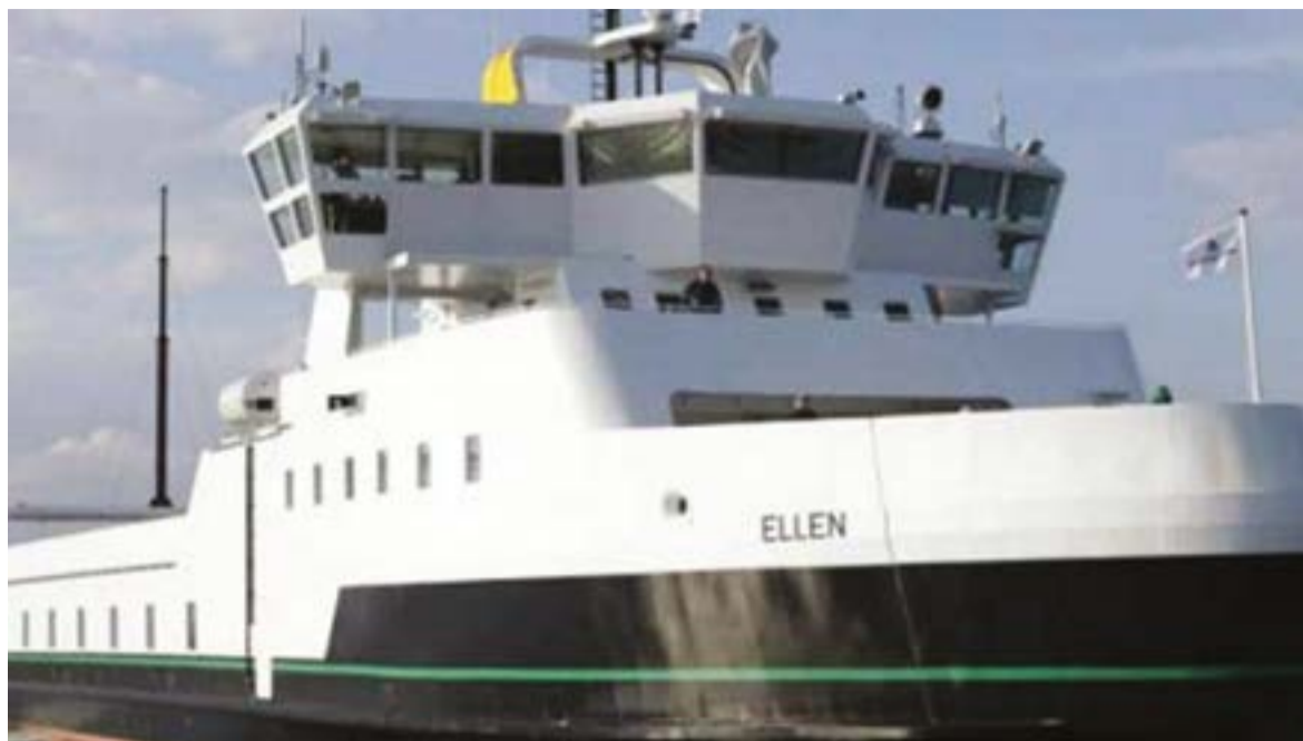
El Ellen puede transportar 30 vehículos, 200 pasajeros y funciona con una batería de 4,3 MWh.
